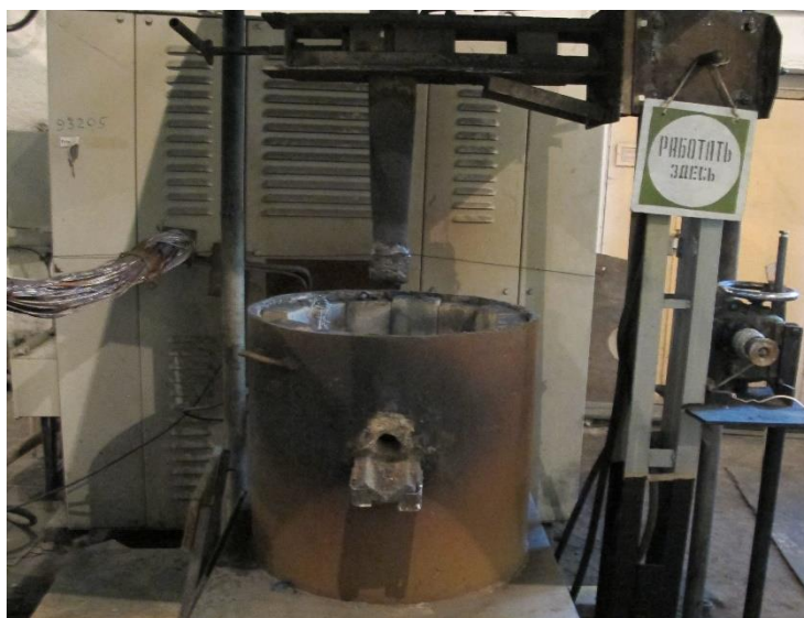
Сурет 4.2 – Қуаттылығы 150 кВА электрдоғалы пеші
