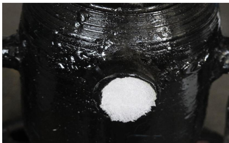
Сурет 4.4 – Имитациялық бөлу құрылғысы бар конвертер моделі
